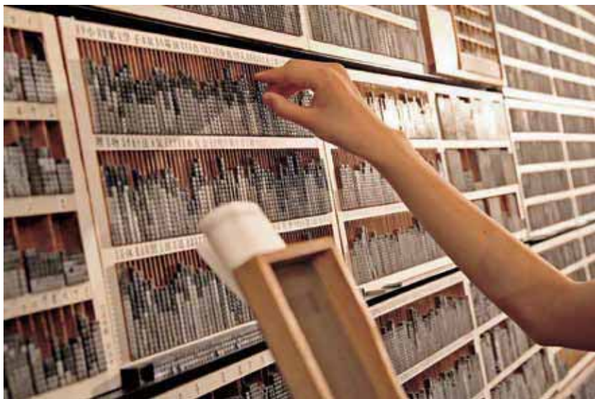
数千、数万ある活字の中から必要なものを集める技はまさに職人! 写真提供:印刷博物館
